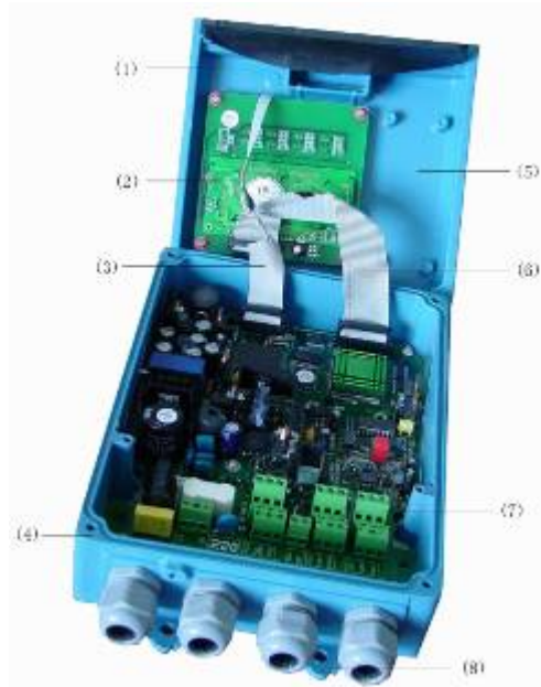
图 4.2(a) 方表小液晶无通讯分体式剖面图
