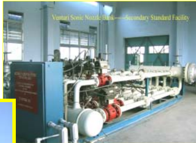
音速喷嘴次级天然气标准装置
